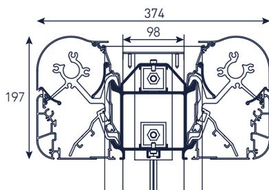
Eine Twinstor lässt sich nicht nur mit Bodenankern, sondern auch in Blumenkästen mit Verstärkungsprofilen befestigen.
